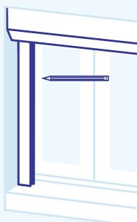
À l'aide d'un crayon ou d'un tournevis, par les trous des coulisses, **marquer sur la maçonnerie TOUS les points de fixation des deux coulisses sur son support.**
