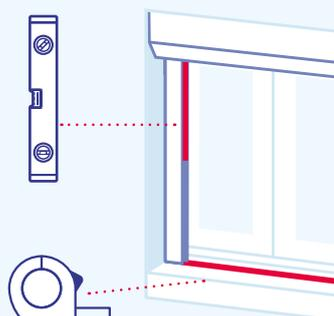
Contrôler l'aplomb avec le niveau à bulles en vérifiant notamment que l'angle entre la coulisse et le coffre soit de 90°.
