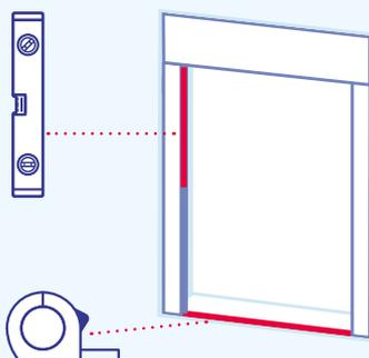
À l'aide d'un crayon ou d'un tournevis, par les trous des coulisses, **marquer sur la maçonnerie TOUS les points de fixation des deux coulisses sur son support.**
