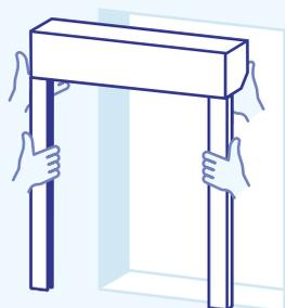
Contrôler l'aplomb avec le niveau à bulles en vérifiant notamment que l'angle entre la coulisse et le coffre soit de 90°.
