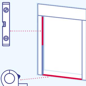
Contrôler à nouveau l'aplomb avec le niveau à bulles et l'écart avec le mètre ruban. Si nécessaire, positionner les cales afin d'obtenir un écartement identique des deux coulisses, du haut jusqu'en bas.
