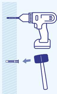
Ressortir l'ensemble pour procéder au **perçage des trous marqués** avec une perceuse adaptée et à la **mise en place des chevilles** (diamètre 6mm).
